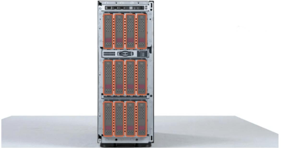
در کل 8 عدد اسلات PCIe 3.0 در این مدل وجود دارد. برای افزایش بهره وری گرافیکی بر اساس نیاز کسب و کار، می‌توان تا 4 عدد کارت گرافیک در این مدل استفاده نمود. کارتهای گرافیک زیر با این مدل سرور سازگار می‌باشد:
