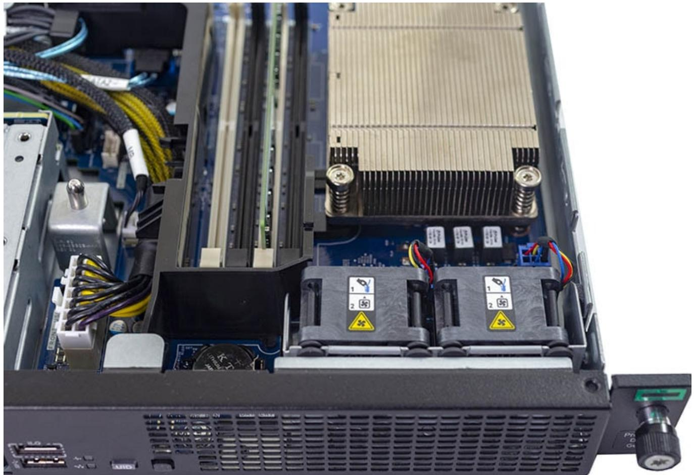
با یک جستجوی ساده برای مدل پردازنده های نامبرده در گوگل به این مسئله می رسیم که تمام پردازنده ها فرکانس پردازشی بالایی داشته اما تعداد هسته پردازشی کمی دارند. برای جایگاه پردازنده و همچنین دمندگی هوا به درون سرور، دو فن کوچک جلوی سوکت پردازنده تعییه شده است. یک فن کوچک دیگر تقریبا در وسط سرور با زاویه ای به سمت رایزر تعییه شده است. کلیه فن ها با سیم مخصوص به مادربرد متصل هستند و خاصیت Hot Plug ندارند.
